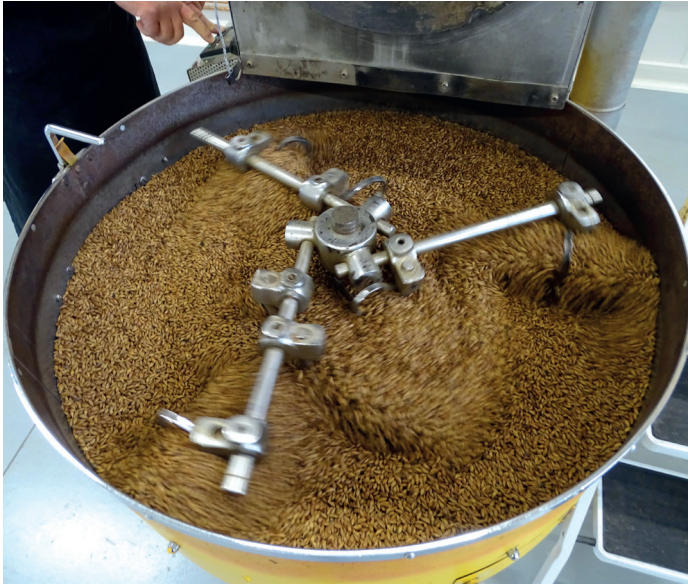
La torréfaction de l'orge pour la préparation de l'orzo.
