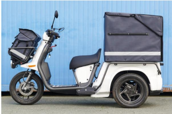
Pulse 3, triporteur pendulaire, est un « cargo scooter » électrique.
